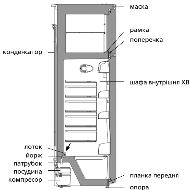
Рисунок 4 – Схема зливу талої води із ХВ
