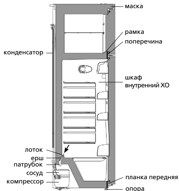
Рисунок 4 — Схема слива талой воды из ХО
